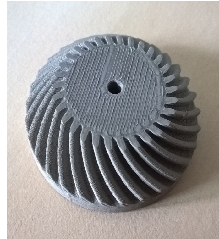
Beispiel eines 3D-Druck-Bauteils aus \text{Si}_3\text{N}_4 : Kegelzahnrad, „as fired“ Außendurchmesser: 33,5 mm Höhe gesamt: 11,2 mm
